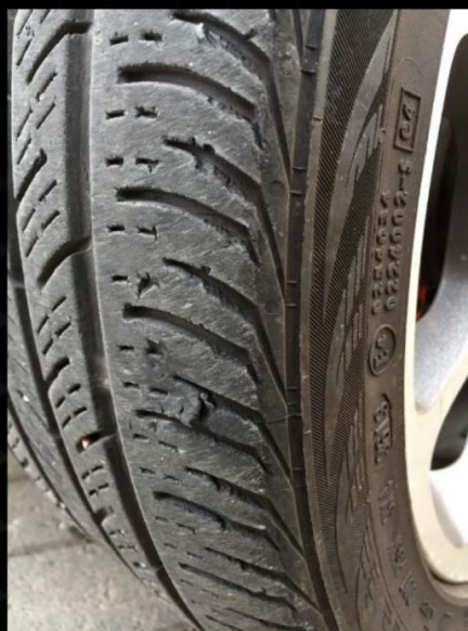
Exemplo de banda de rodagem com arrancamentos.
