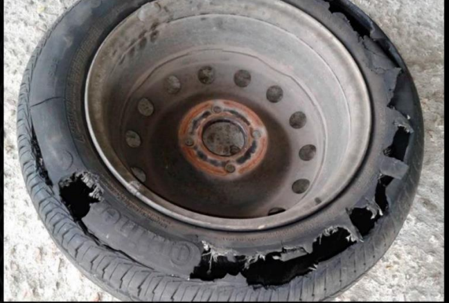
Aparência de um pneu com degradação severa e separação total dos componentes, por rodagem com baixa pressão.
