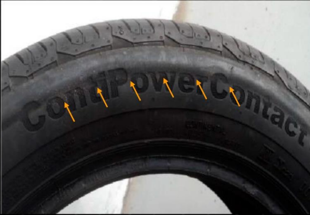
Aparência de um pneu com degradação superficial.
